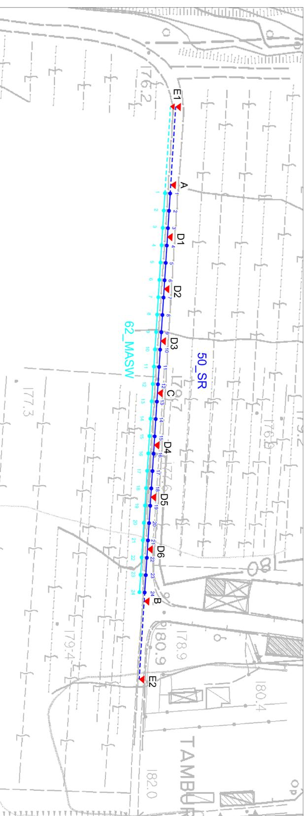
57\_SR PROVA SISMICA A RIFRAZIONE ONDE P E ONDE SH E 63\_MASW - SCALA 1:500
